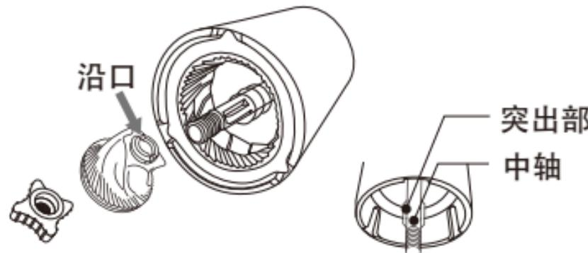
在本体的中轴突出部, 将固定芯的沿口对准插好。最后安装粗细(粒度)调换钮。
