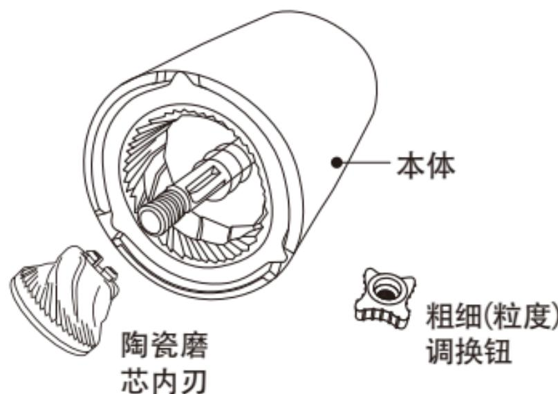
旋转粗细(粒度)调换钮后, 卸下陶瓷磨芯内刃。
