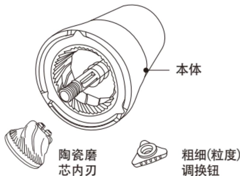
旋转粗细(粒度)调换钮后，卸下陶瓷磨芯内刃。
