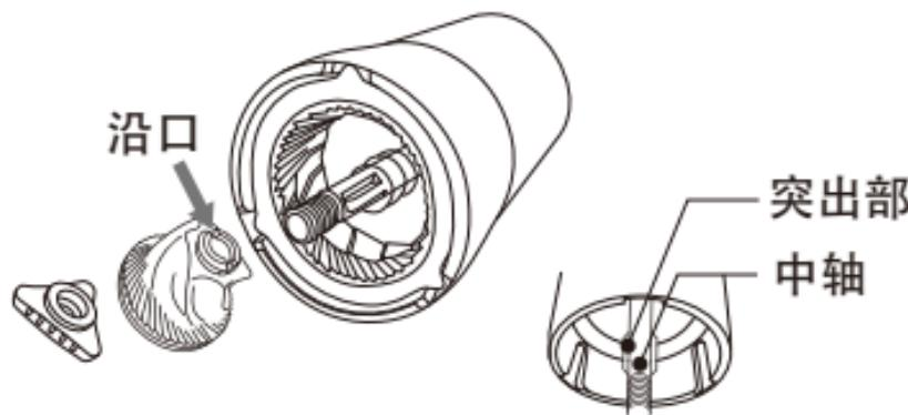
在本体的中轴突出部，将固定芯的沿口对准插好。最后安装粗细(粒度)调换钮。
