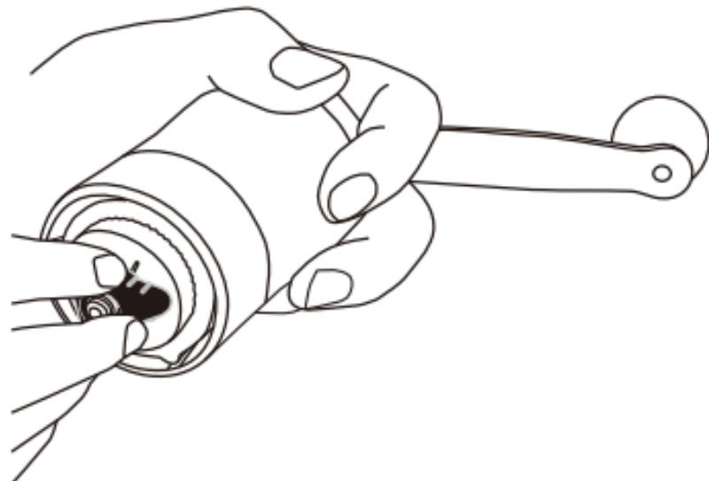
安装好摇杆,请压住后再旋调粗细(粒度)
