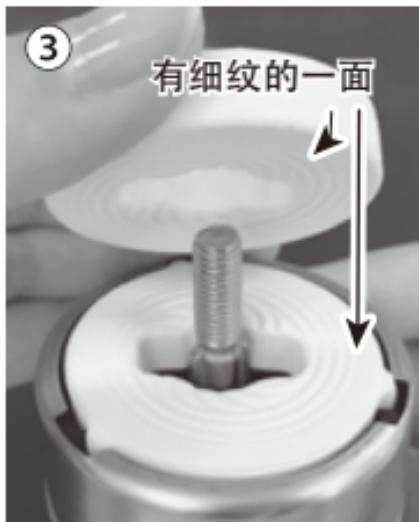
将有细纹的一面朝下后安装磨芯下刃。
